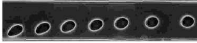
FIGURE 1.15: Migration d'une vésicule vers l'axe d'un canal microfluidique (images juxtaposées) [36]
