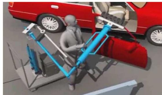
FIGURE 2.1 – Un homme et un robot en collaboration pour transporter un objet volumineux dans un environnement contraint (à gauche) et démonstration de la façon dont un être humain peut interagir physiquement avec un manipulateur, pour enlever la portière d'une voiture : réalisation de la tâche de désassemblage (à droite) .
