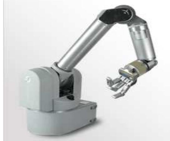
FIGURE 2.17 – Le robot WAM<sup>TM</sup> de Barrett Technology.
