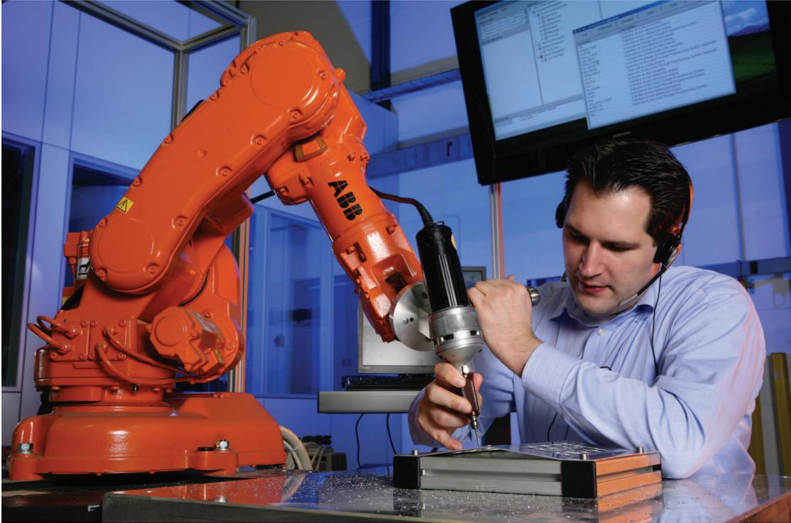
FIGURE 2.6 – programmation par démonstration (lead-through programming)
