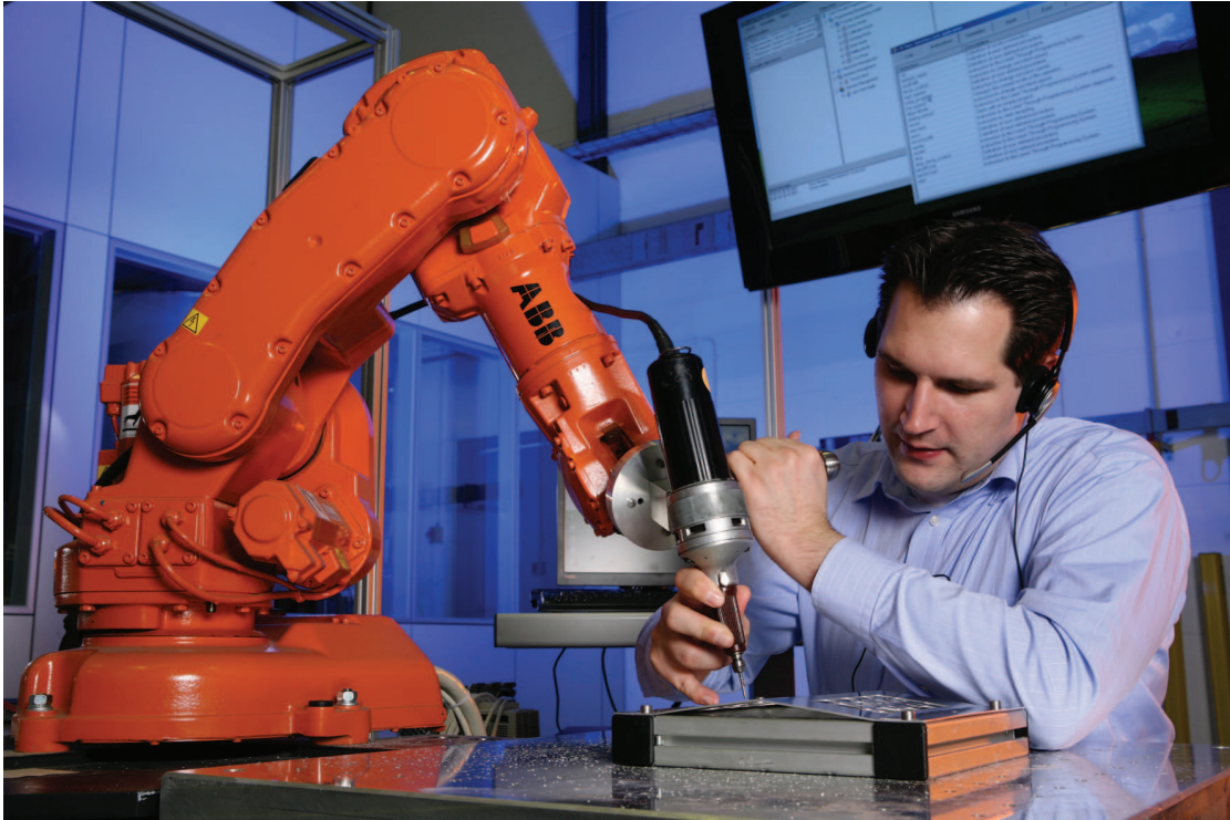
FIGURE 2.6 – programmation par démonstration (lead-through programming)
