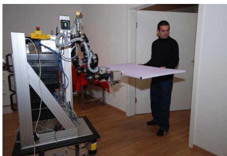
FIGURE 2.1 – Un homme et un robot en collaboration pour transporter un objet volumineux dans un environnement contraint (à gauche) et démonstration de la façon dont un être humain peut interagir physiquement avec un manipulateur, pour enlever la portière d'une voiture : réalisation de la tâche de désassemblage (à droite) .
