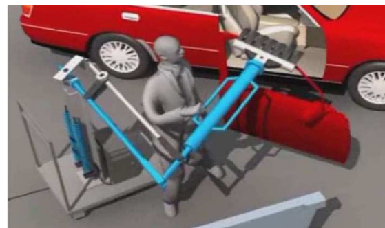
FIGURE 2.1 – Un homme et un robot en collaboration pour transporter un objet volumineux dans un environnement contraint (à gauche) et démonstration de la façon dont un être humain peut interagir physiquement avec un manipulateur, pour enlever la portière d'une voiture : réalisation de la tâche de désassemblage (à droite) .
