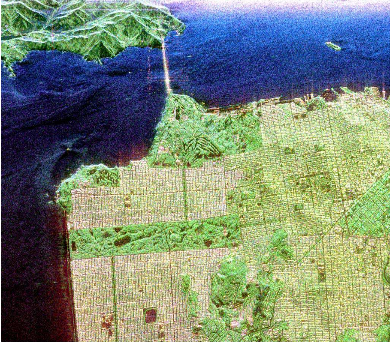
FIGURE 1.6 – Baie de San Francisco dans la base de Pauli : S_{HH} - S_{VV} , \sqrt{2}S_{HV} , S_{HH} + S_{VV}
