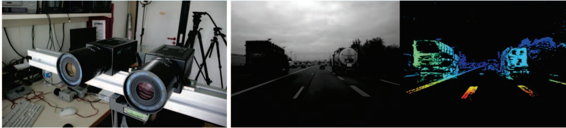
FIGURE I.5. Système stéréoscopique expérimental (LEOST) à gauche et image d'une scène prise par un système stéréoscopique et sa carte de disparité à droite
