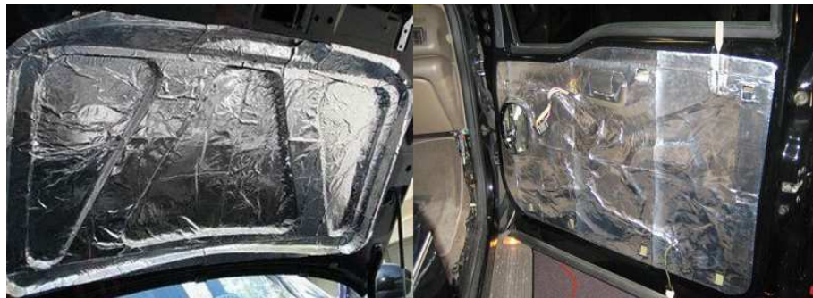
FIGURE 1.2 – Exemple d'utilisation de patches viscoélastiques.
