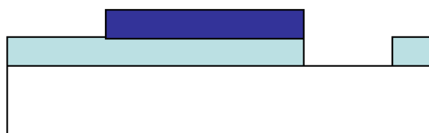
3. Dépôt par spin coating, gravure et recuit thermique sous vide du PEDOT : PSS
