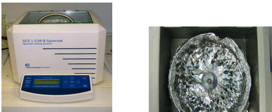
Fig. 6. 5 : Photos du Modèle de l'appareil G3P-8 Spincoat (gauche); Parois intérieures de l'enceinte après dépôt
