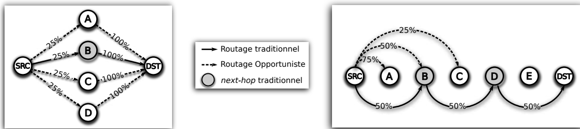
Figure 3.7 – Le routage opportuniste exploite la diversité des chemins et peut faire des progrès vers la destination de façon plus efficace qu’en routage traditionnel
