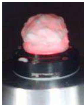
Figure 45. Image de la mousse à raser Gillette au cours d'un test de diffusion de lumière montrant une forte diffusion dans toutes les directions et une importante intensité transmise malgré l'épaisseur importante de la mousse.
