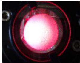
Figure 5. Exemple de positionnement de la tache laser sur la surface de la mousse à raser avant de commencer les tests.
