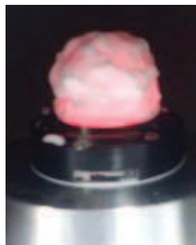
Figure 45. Image de la mousse à raser Gillette au cours d'un test de diffusion de lumière montrant une forte diffusion dans toutes les directions et une importante intensité transmise malgré l'épaisseur importante de la mousse.
