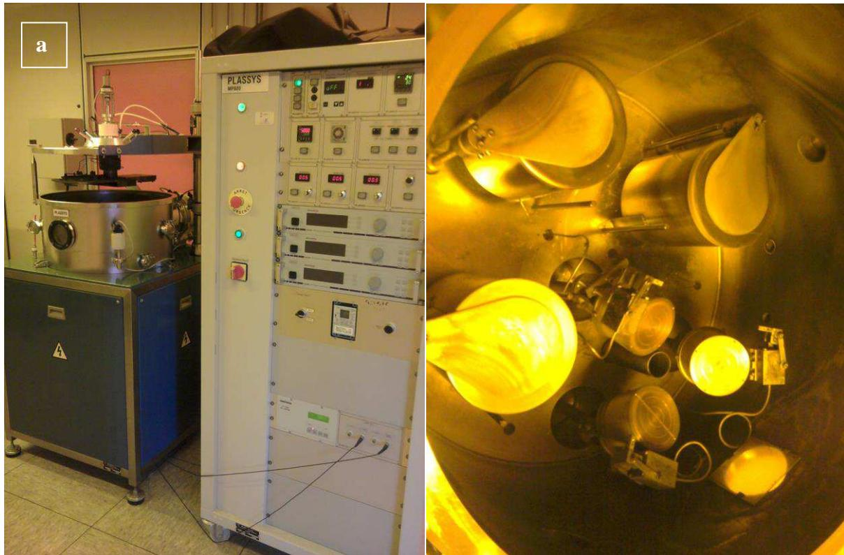
*Figure 2-10 : a) Photo de l'ensemble du bâti de pulvérisation MP600 commercialisé par la société Plassys (à gauche l'enceinte contenant les cathodes, à droite l'armoire électrique contenant notamment les générateurs rf) ; b) photo de l'intérieur de l'enceinte contenant trois cathodes et un bloc de co-pulvérisation*
