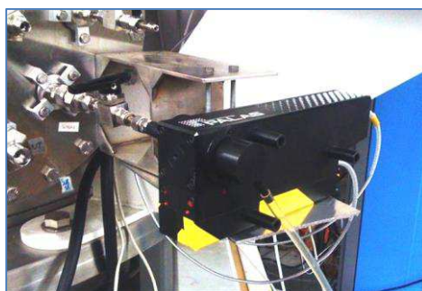
Figure 34 Photographie de la tête de prélèvement du compteur optique Welas® connecté à CESAM.
