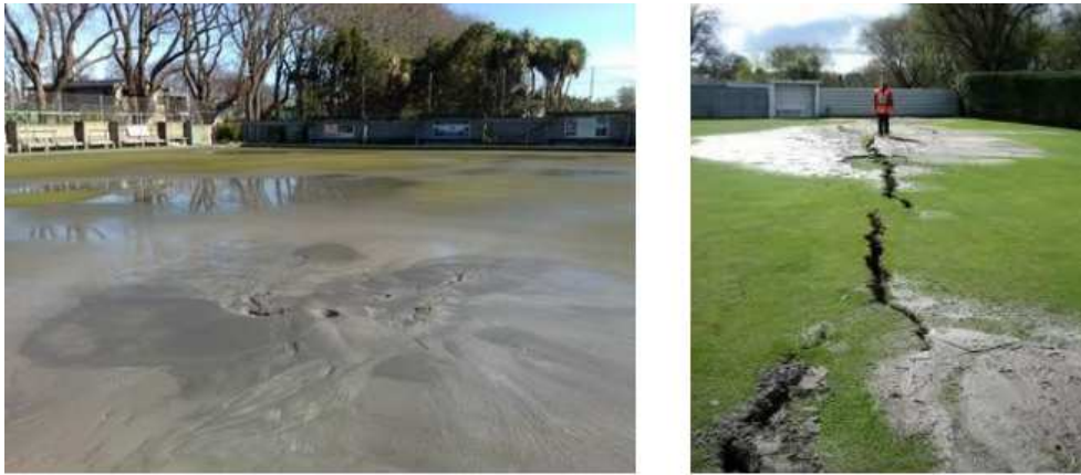
FIGURE 1.4.3: Volcans de sable dus à la liquéfaction, après le tremblement de terre de Christchurch, Nouvelle Zélande (2011)
