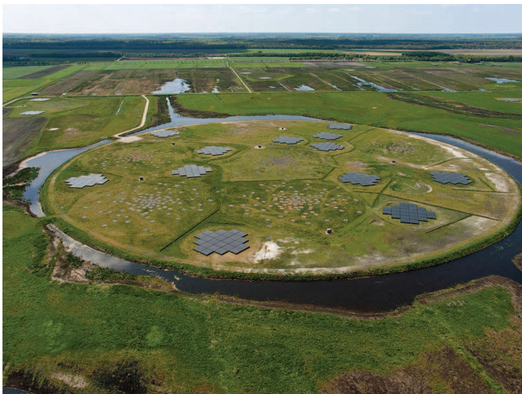
FIG. 1.15 – Exemple de stations LOFAR (Le LOFAR ‘superterp’) : six stations sont représentées situées à coté du village de Exloo au Pays-Bas. Crédit : Top-Foto, Assen.
