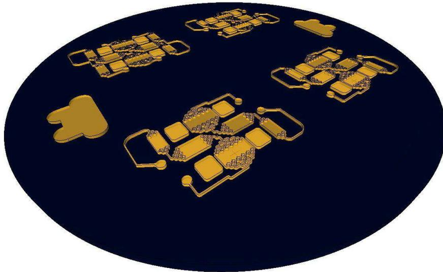
*Figure 3-20 « Wafer » de silicium (3 pouces de diamètre et 1000  $\mu\text{m}$  d'épaisseur) avec motifs microfluidiques en SU8*
