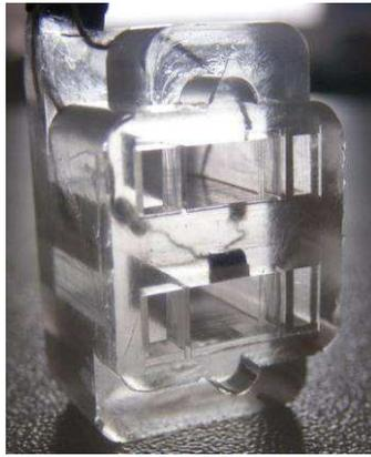
Photo 3-1 Puce PDMS PHS2, comportant une sonde PT100 intégrée à la base de l'une des chambres d'analyse
