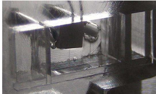
*Photo 3-2 Vue de dessous de la partie centrale d'une puce PHD1, on distingue les trois cavités et les murs de 250 µm (cavité d'analyse de 1250 µm)*
