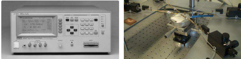
Fig. N°IV.3 : Dispositif expérimental : a°) LCRmètre HP 4284A ; b°) Testeur 4 points
