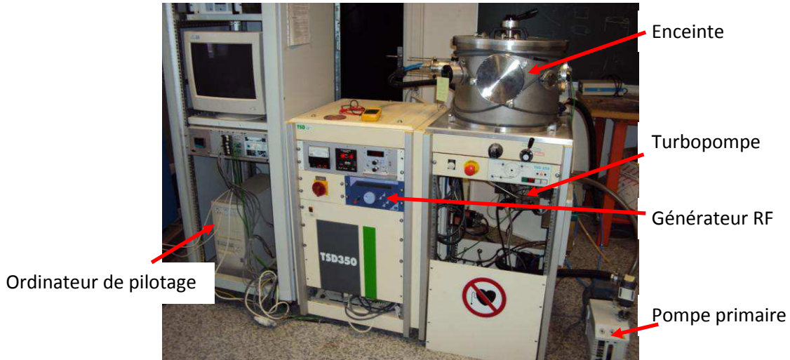
Fig. n°III.11 : Dispositif expérimental de pulvérisation cathodique RF
