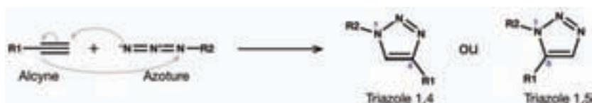
**Figure 42 - Réaction de cycloaddition 1,3-dipolaire azoture/alcyne de Huisgen**
