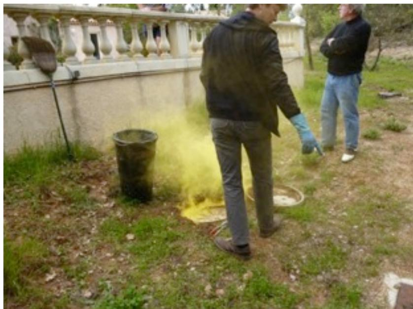
**Illustration 3 : Photographie d'un contrôle d'une installation existante : utilisation d'un fumigène**
