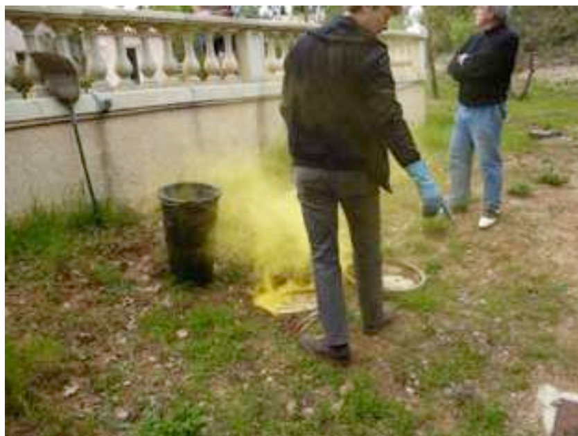
Illustration 3 : Photographie d'un contrôle d'une installation existante : utilisation d'un fumigène Source : ROLLIN J., 2012.
