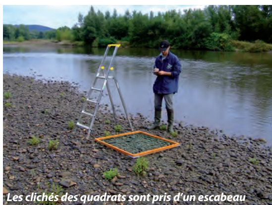
Figure M11 - Test d'une méthode de mesure automatisée de la granulométrie sur la rivière Allier
