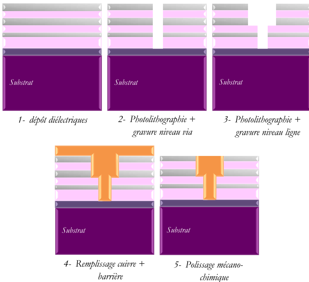
Figure III.12. Procédé damascène pour le remplissage des lignes cuivre
