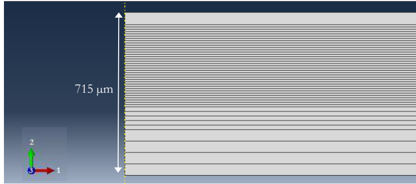
Figure III.22. Partition du substrat de Silicium pour la simulation de son amincissement
