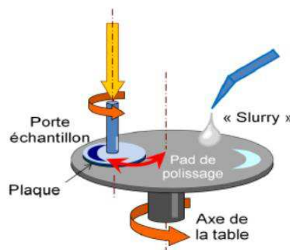
Figure I.10. Principe du polissage mécano-chimique
