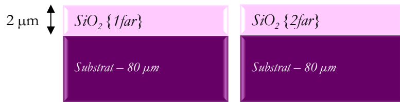
Figure IV.15. Echantillon des couches face arrière à caractériser en température
