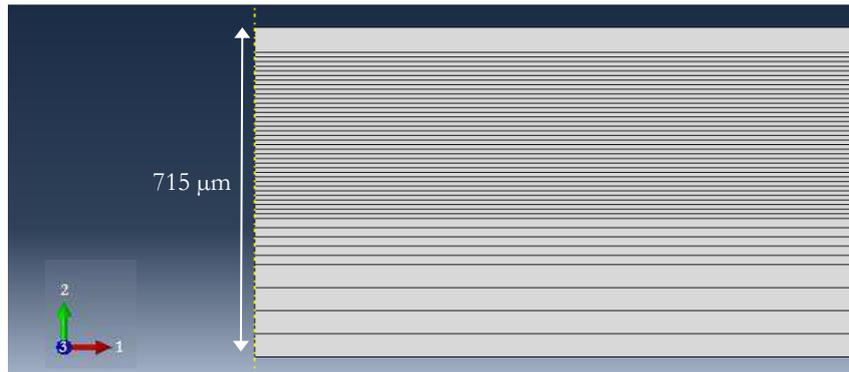
**Figure III.22.** Partition du substrat de Silicium pour la simulation de son amincissement
