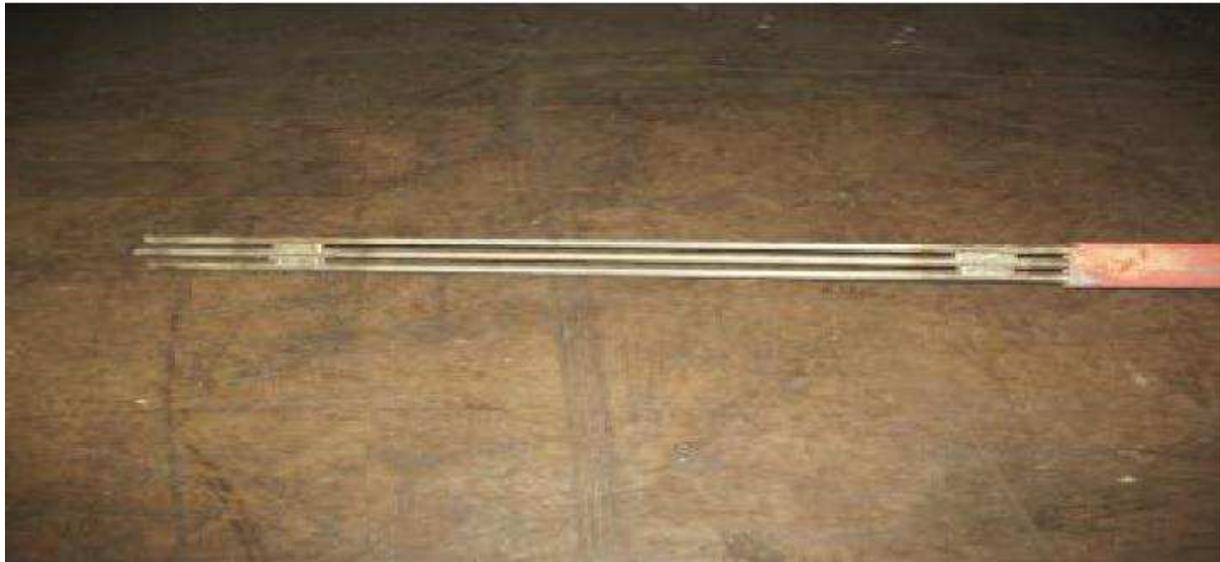
**Figure III.2 : Sonde triple.**
