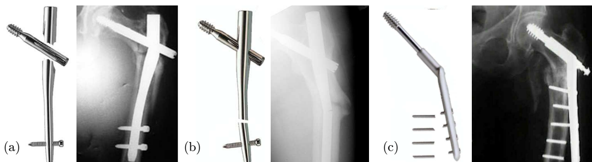
Figure 1.24 – Cas de rupture (a) et (b) du clou GAMMA et (c) de la plaque DHS.
