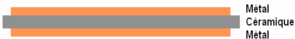
Figure I-17: Substrat céramique avec des métallisations
