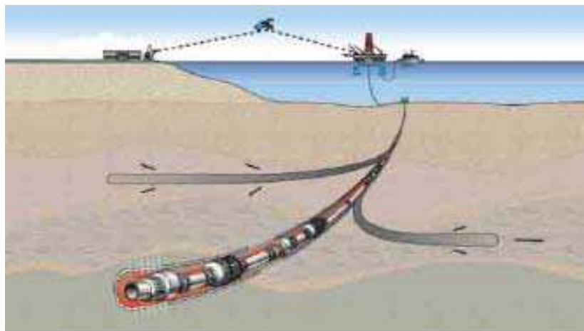
Figure I-5 : Développement d'un système de forage autonome [Bosw-98]
