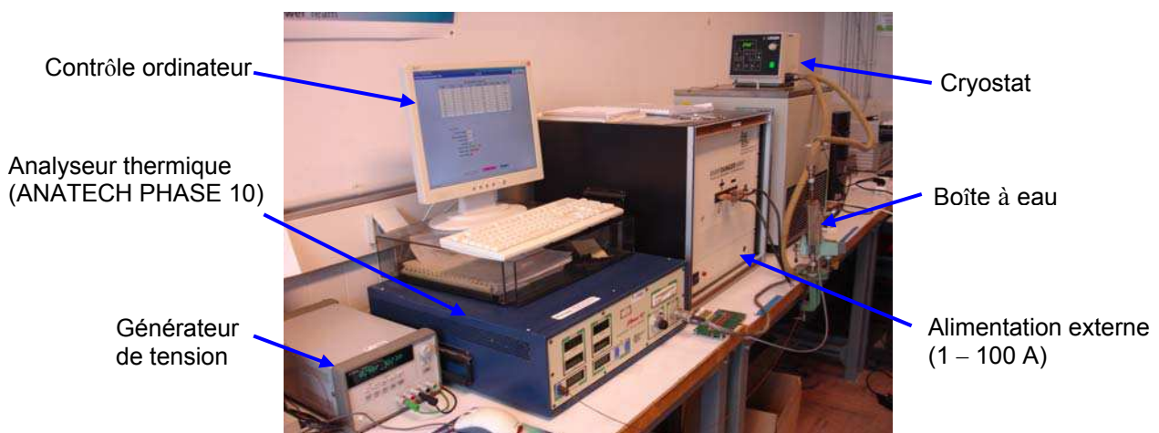
Figure III-4: Banc de mesure de résistance thermique et l'impédance thermique
