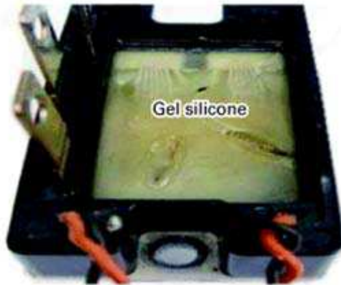
Figure I-25 : Module de puissance rempli de gel silicone [Rich-05]
