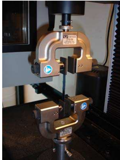
Figure 4.7 Traction uniaxiale sur une lamelle de silicium brut
