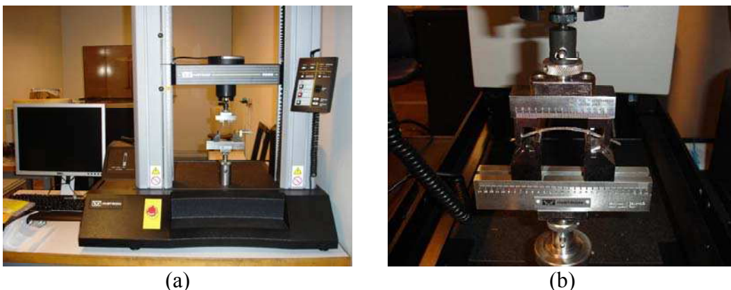
Figure 4.16 (a) Dispositif expérimental de flexion quatre points (b) Lamelle sous chargement de flexion
