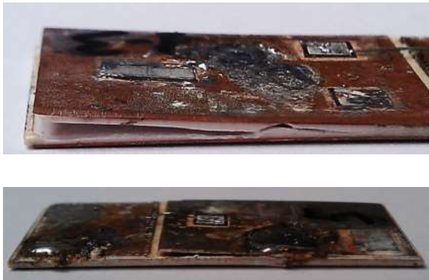
Figure 2.23 : Exemples de défaillances dans des assemblages de puissance (substrat DBC CuAg sélectif – fissuration de la céramique après 2800 cycles et délaminage de la métallisation après 2800 cycles
