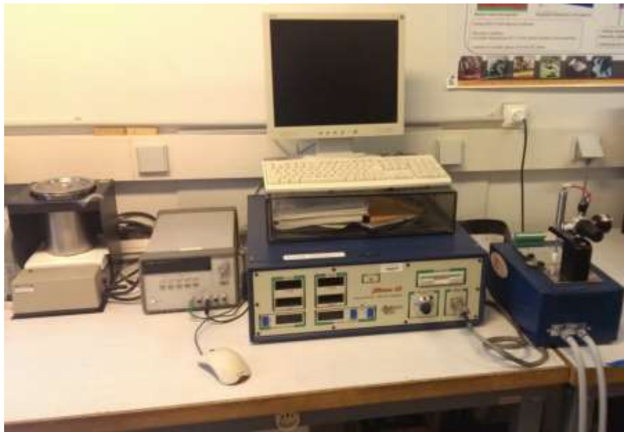
Figure 2.16 : Banc de mesure de la résistance thermique : banc de calibration (gauche), DeltaVbemètre Analysis Tech Phase 10 thermal analyzer (milieu) et boîte à eau régulé par un cryostat (droite)
