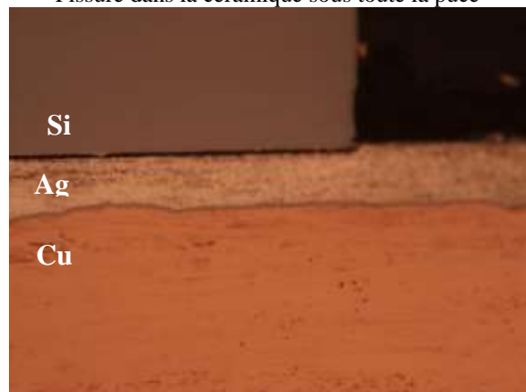
Assemblage H (puce moyenne) 2000 cycles Delaminage entre la puce et l'argent
