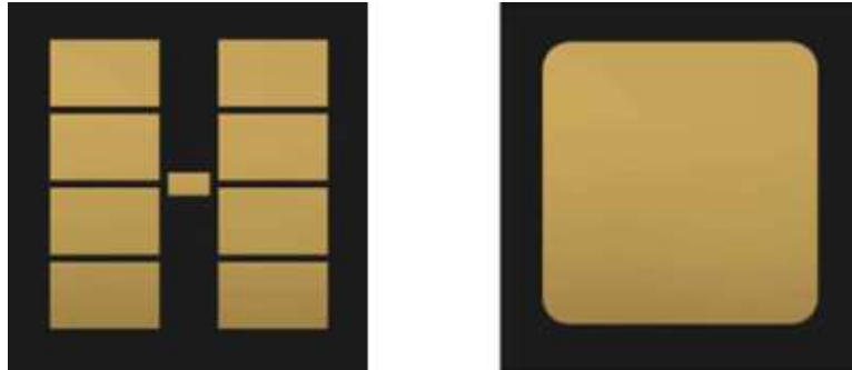
Figure 1.2 : Puces de type IGBT (gauche) et de type diode (droite)
