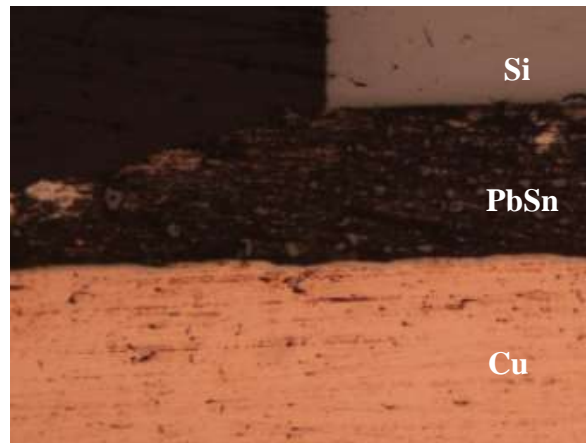
Assemblages B (puce petite) Présence d'intermétallique
