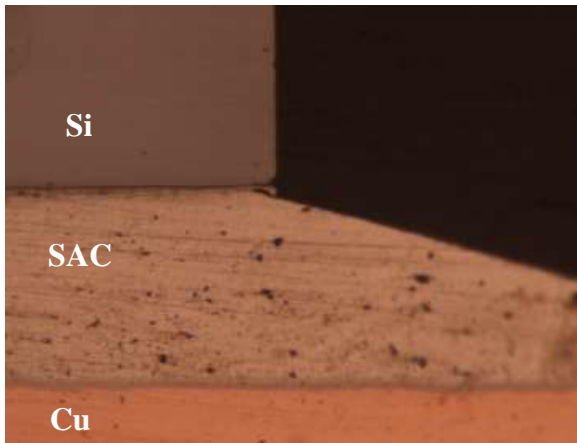
Assemblage D (puce petite) Début de fissure à l'interface puce/brasure Présence d'intermétallique (AuSn)
