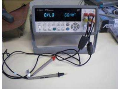
*Figure II - 17 : Multimètre KEITHLEY 2000*
