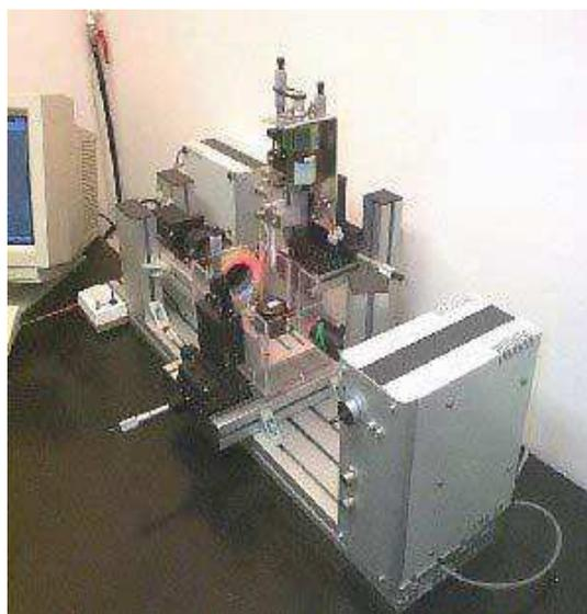
En pratique, une goutte de liquide, en général de l'eau ultra-pure, est déposée à l'aide d'une seringue sur la surface de l'échantillon à analyser.
