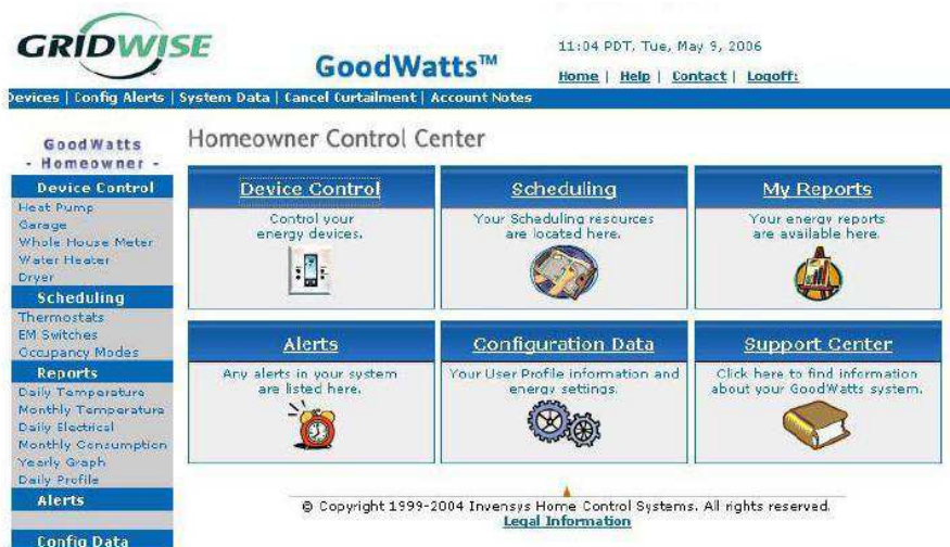
Capture d'écran de l'outil en ligne GoodWatts™ : suivi de consommation, contrôle et programmation des équipements électriques.
