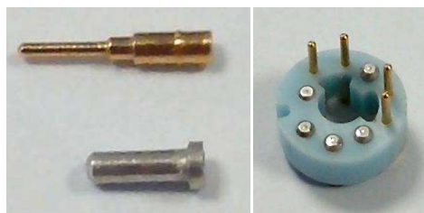
Figure 86. Tulipes assemblées dans le bloc moteur en polymère
