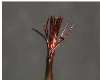
Figure 88. Câble d'alimentation du moteur dénudé
