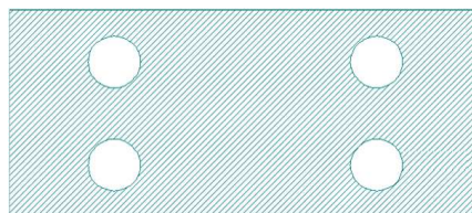
Figure 61. Masque n°2 - Motifs de photolithographie de la membrane SU-8
