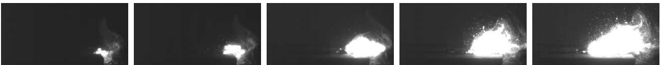
Figure 101. Propagation du front de flamme dans les nano-thermites
