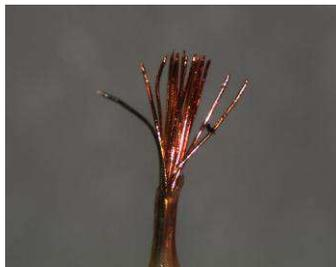
**Figure 88. Câble d'alimentation du moteur dénudé**
