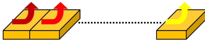
Figure II.29 – Discretisation de la longueur d'une piste de cuivre
