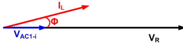
Figure III.11 – Diagramme vectoriel du déphasage du courant I_L et la tension V_R du réseau
