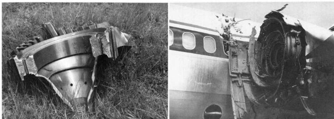
FIGURE 1 – Accident Pensacola, Floride, USA, 06 juillet 1996. Eclatement d'un disque de MD88 Delta Air Lines, Moteur P&W JT8D.
