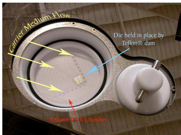
Figure 17: *Vue de dessus du système Omnietch*
