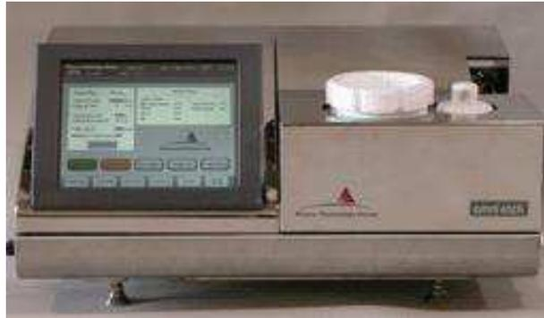
Figure 16: *Omnietch : équipement de retrait couche par couche automatique*
