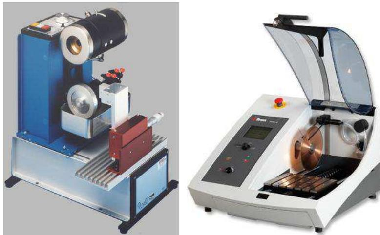
Figure 20: A. Scie à fil B. scie à disque
