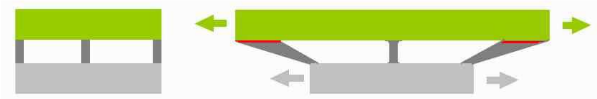
Figure 25 : Différence de dilatation réelle au centre et sur les angles Zones de contraintes en rouge
