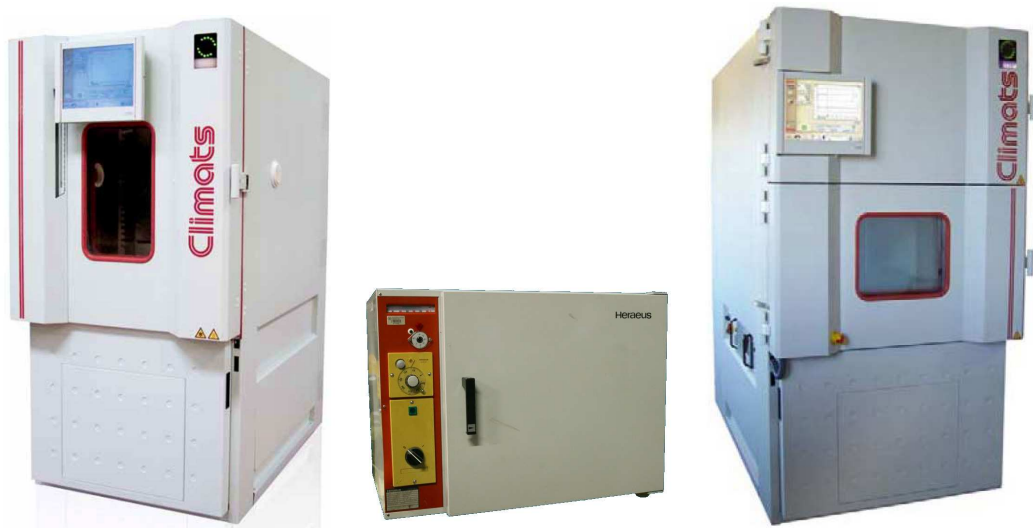
Figure 50 : Étuves d'exposition à l'humidité, à haute température et aux cycles thermiques
