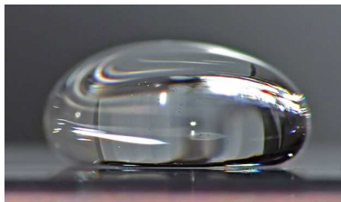
FIGURE 5.2 – Photo d'une goutte d'eau d'environ 4 mm de rayon sur une plaque chauffante à plus de 200 °C. Le nombre de Bond correspondant est ici d'environ 670.
