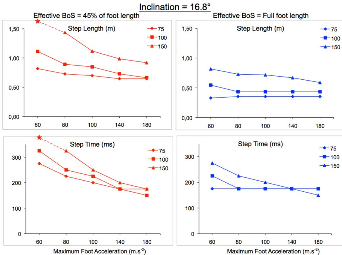
**Figure 6.17:** Longueur et durée des pas de rattrapage simulées pour des perturbations de type tether-release (cf. Chapitre 4), pour 3 différentes valeurs de temps de réaction (75 ms - losanges, 100 ms – carrés et 150 ms – triangles), deux valeurs de longueur effective de la base de support (100% à droite, 45% à gauche) et différents niveaux d'accélération maximale du pied en vol.
