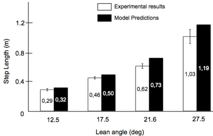
**Figure 6.7:** Longueurs des pas de rattrapage pour le scénarios de Hsiao-Wecksler and Robinovitch (2007): expérimentales (en blanc, moyenne et écart-type) vs simulées par la première version du modèle(noir)
