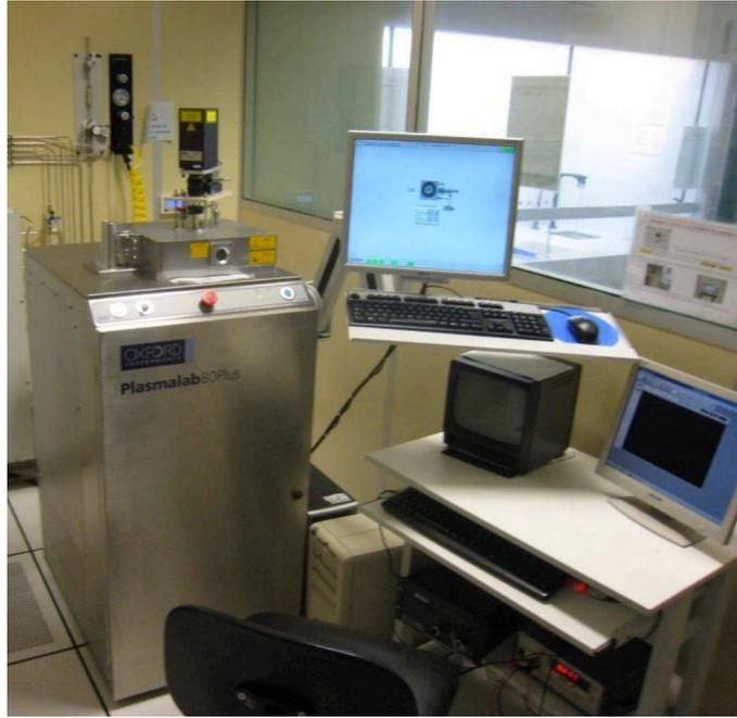
FIGURE 3.11 – Bâti de gravure RIE Plasmalab80 utilisé pour la gravure de  $\text{SiO}_2$ .
