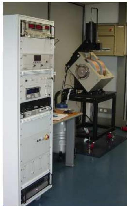
FIGURE 3.12 – Magnétomètre à échantillon vibrant utilisé.
