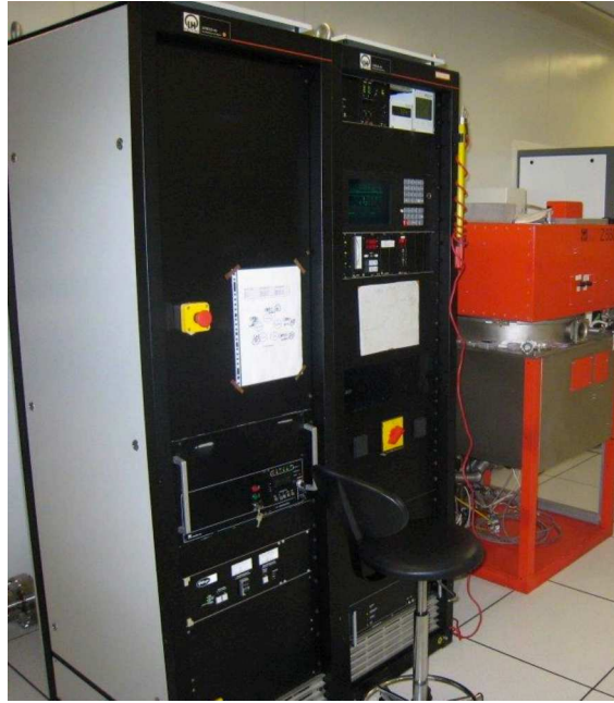
FIGURE 3.9 – Bâti de dépôt de couches minces magnéto-élastiques Leybold Z550.
