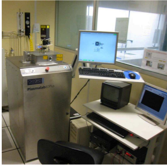
FIGURE 3.11 – Bâti de gravure RIE Plasmalab80 utilisé pour la gravure de \text{SiO}_2 .
