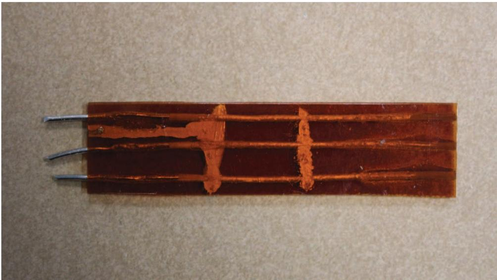
Figure III.45. Photographie d'un patch avec 3 fibres terminé.
