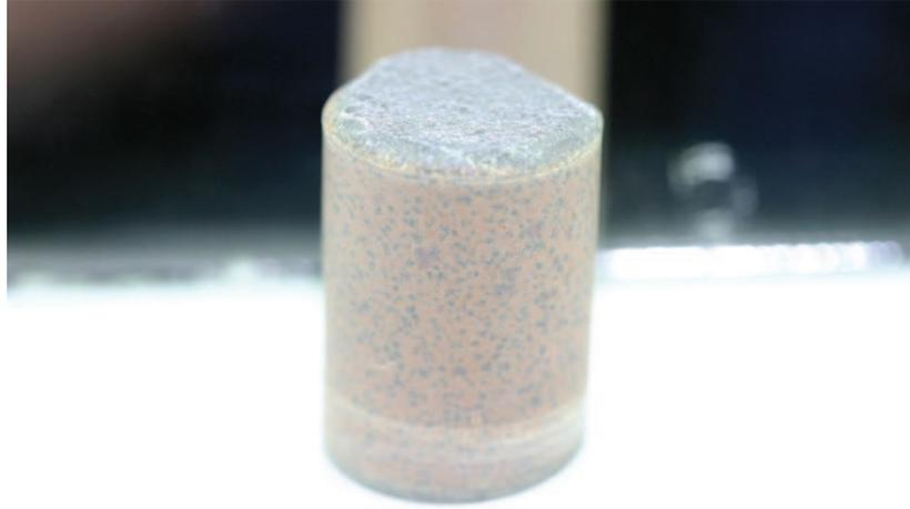
Figure V.12. Photographie d'un échantillon massif carotté avec additifs (ajoutés par voie liquide au planétaire) frittés à 950°C pendant 6 heures.
