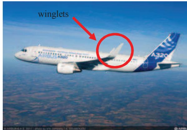
Figure I.1. Exemple de winglets sur un gros porteur d'Airbus ([www.airbus.com](http://www.airbus.com)).
