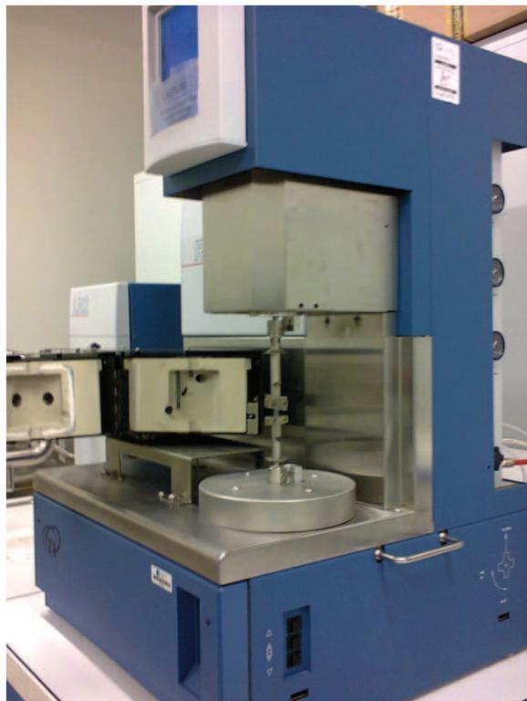
Figure III.54. Dispositif de micro-traction de l'UMET.
