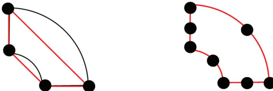
Figure IV.19. Fonctions d'interpolation linéaire et quadratique pour des éléments de surface à 4 côtés pour la discrétisation d'une surface à frontières non linéaires.
