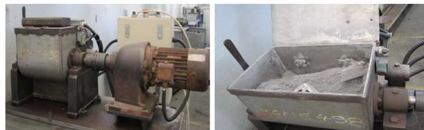
*Figure III-4. Le mélangeur du laboratoire*
