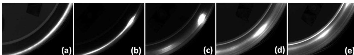
Figure II-19. Thermogrammes du disque à différents instants du premier freinage de ralentissement a) 0,7 s, b) 2,5 s, c) 5,6 s, d) 6,7 s, e) 13,3 s
