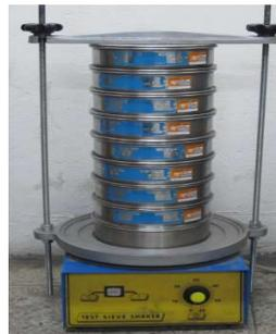
Figure III-6. Tamiseur vibratoire pour les tests de granulométrie
