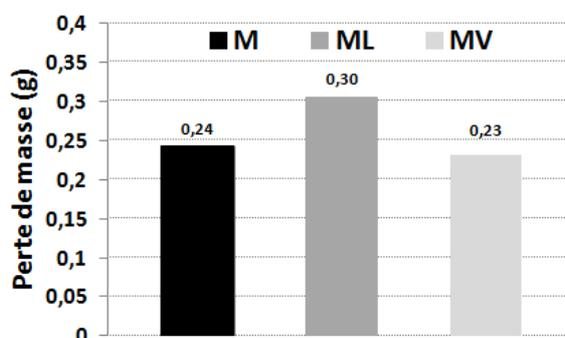
Figure IV-13. Estimation de perte de masse après les essais de freinages de ralentissements successifs des garnitures M, ML et MV
