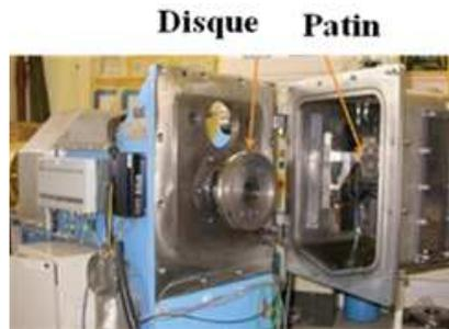
Figure II-11. Tribomètre de freinage
