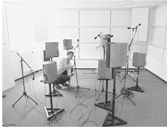
FIGURE 5.5 – Installation à l’IRISA pour une expérience de mesure simultanée des réponses de salles.
