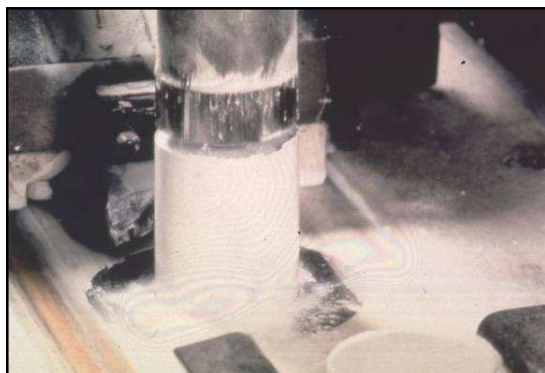
Figure 20 : Compressage de la poudre d'alumine. (Photos CeramTec)
