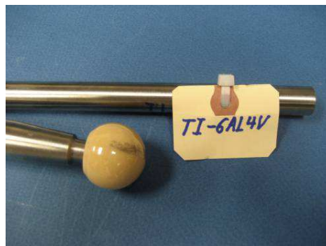
Figure 54 : transfert de particules métalliques sur la tête céramique
