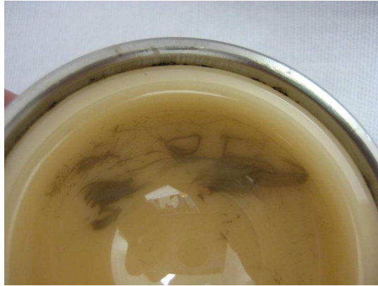
Figure 62 : Transfert métallique sur l'insert céramique
