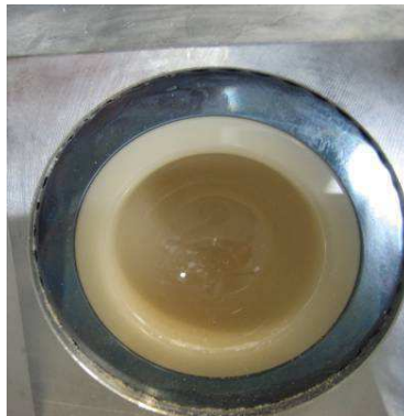
Figure 55 : Edge wear sur l'insert céramique
