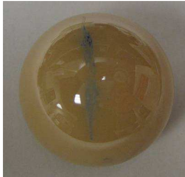
Figure 53 : Stripe wear sur la tête céramique, colorée au bleu de méthylène
