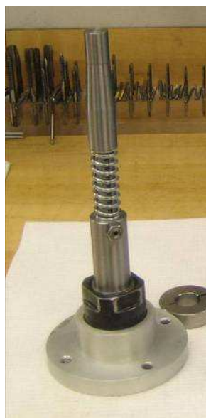
Figure 45 : Manchon métallique supportant la tête céramique
