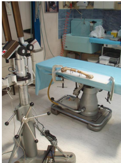
Figure 61. Vue d'ensemble de la manipulation avec le bras Faro.
