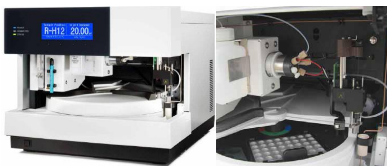
Figure 46 : Photos du passeur d'échantillon de la chaîne U3000 (Thermo Fischer Scientific).
