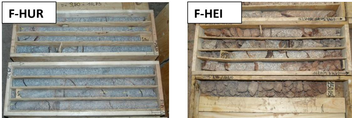
Figure II-2 : photos d'une partie du profil carotté dans le granite porphyroïde, à gauche le granite prélevé le long du profil F-HUR et à droite le granite prélevé dans le puits F-HEI.
