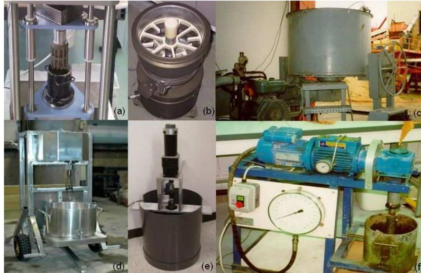
**Figure 1.5** Rhéomètres à bétons existants : BML (a) ; BT Rhéom (b); Cemagref (c); IBB (d); ICAR (e); Two point test (f)
