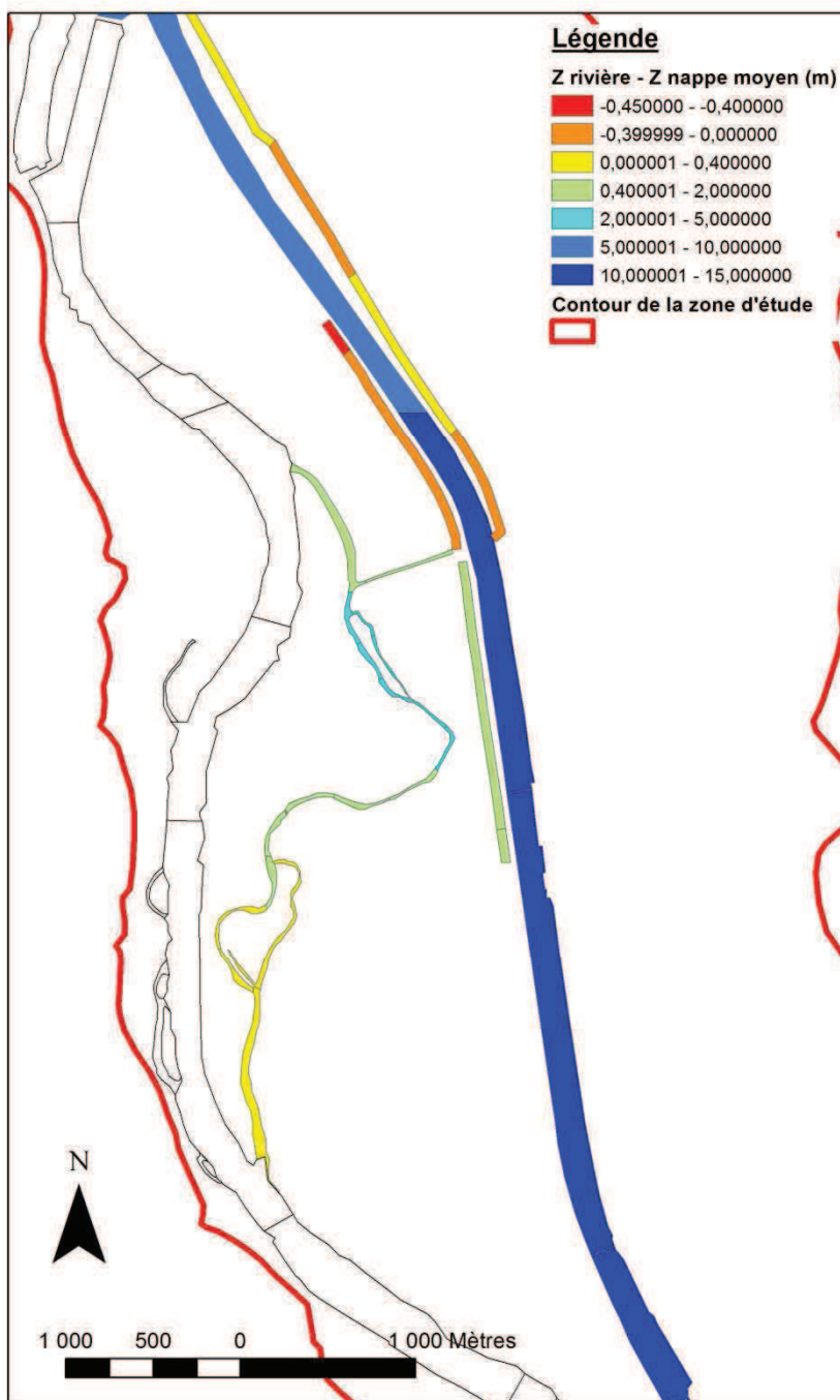
Figure 134: Différence moyenne de niveau d'eau entre la nappe et les eaux de surface
